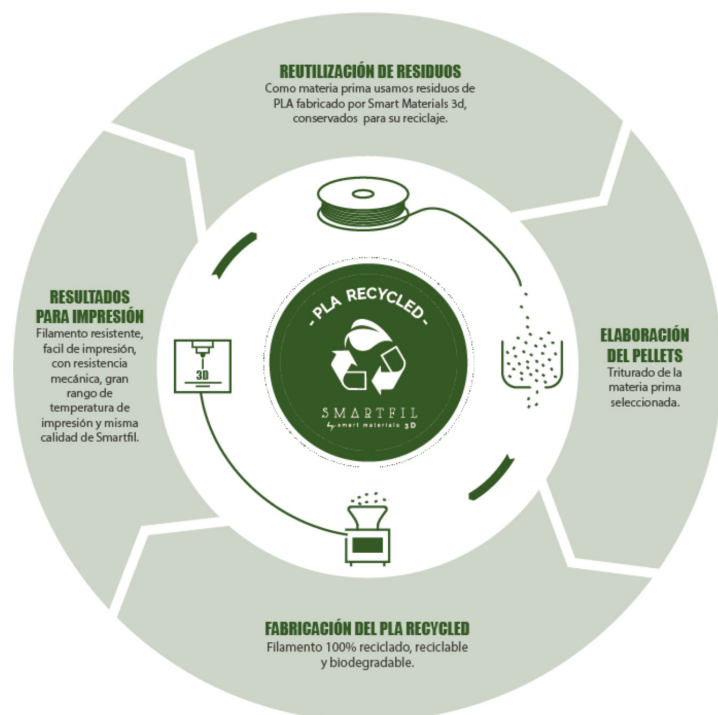
Fig. 212. Proceso de obtención de PLA Reciclado en Smart Materials
