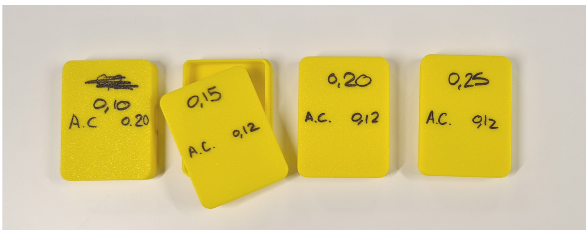
Fig. 196. Pruebas de impresión con distintas tolerancias y alturas de capa
