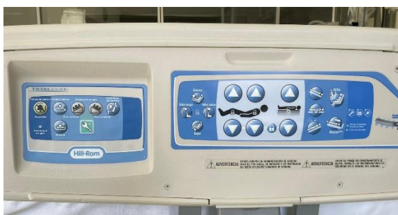
Figura 12: Panel de control SEMP de presión alterna. Cortesía UCI, HUBU (2023)
