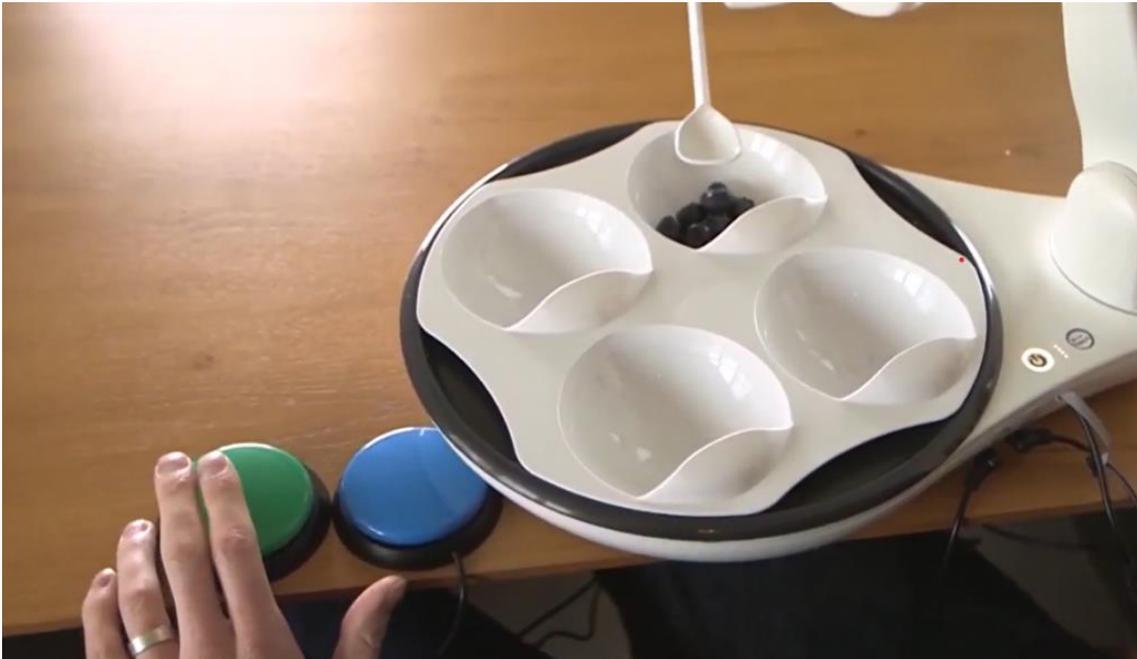
*Figura 13. Interruptores que activan las entradas Jack del OBI (Fuente: [58])*
