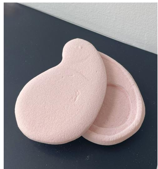
Además, se trata de probar el mencionado sistema de apertura basada en el giro de un cuerpo sobre el otro, o cizallado. Este resulta fácil de manejar con una mano, con la posibilidad de utilizar otros objetos, como mesas o paredes, para ayudar en el proceso de apertura y cierre.
