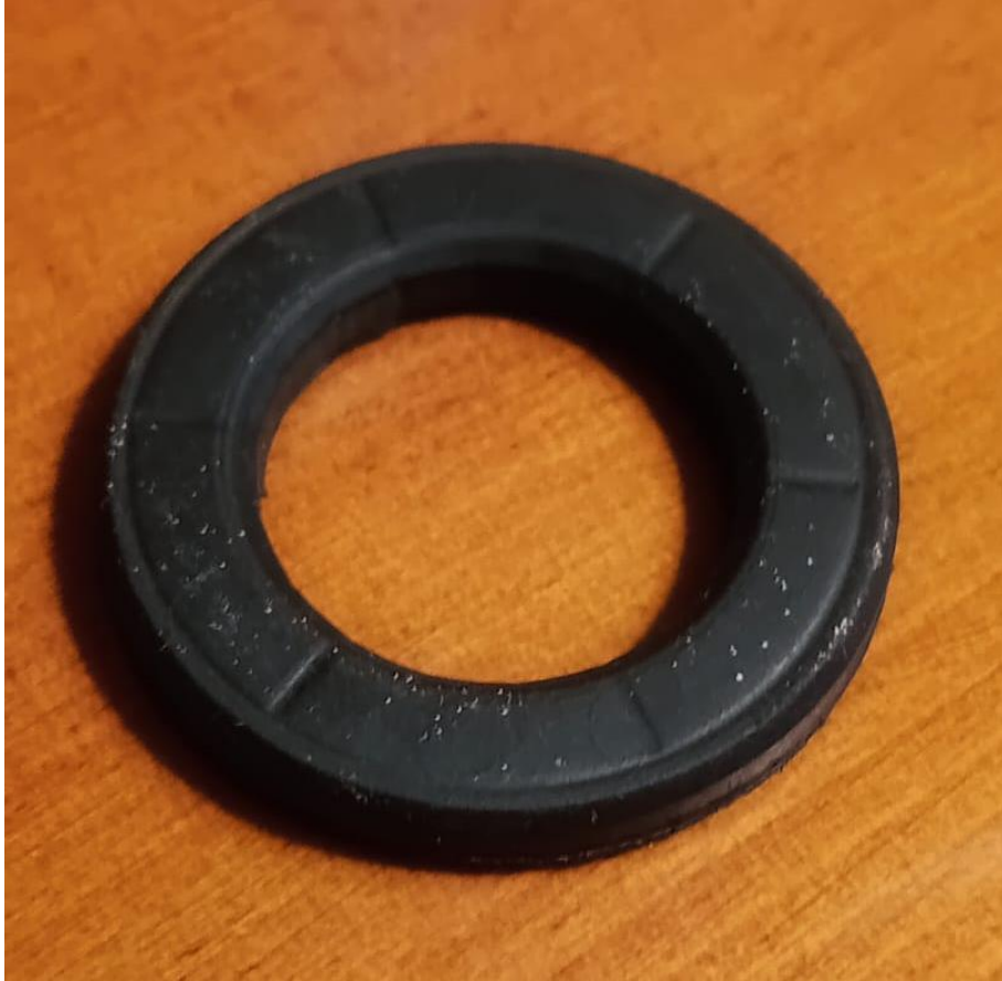
Figura 46. Vista superior junta
