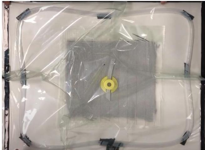
Figura 40: Proceso de lay-up para una placa de material compuesto [24]
