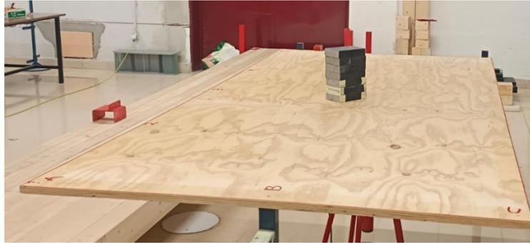
Figura 17, detalle de la placa cargada en situación "triapoyada".
