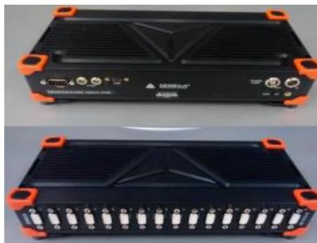
*Figura 11, tarjeta de adquisición de datos SIRIUS HD-SGT.*
