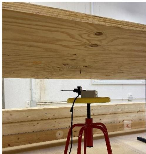
Figura 14, láser de medida situado en el centro de la placa
