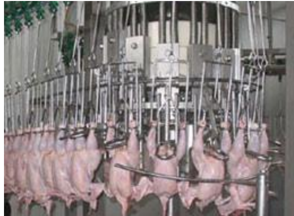
Figura 2: Carrusel con dispositivos móviles para la evisceración. Imagen sacada de: https://www.poultryprocessingequipment.com/evisceration_equipment/
