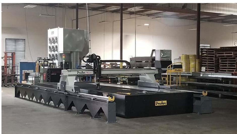
*Ilustración 7.-Cortadora de plasma [9]*
