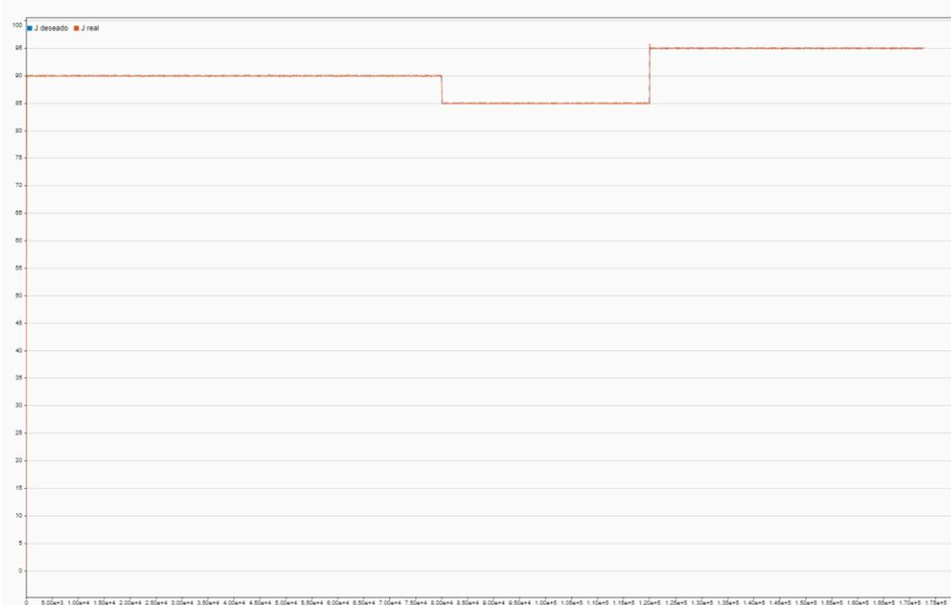
Figura 38. Gráfico que muestra la señal de referencia (en color azul) y la señal real (en color naranja) del tanto por ciento de CO<sub>2</sub> capturado para el escenario 2 y el control MPC. El eje x indica el tiempo en segundos, y el eje y muestra el porcentaje de CO<sub>2</sub> capturado. Elaboración propia con MATLAB/Simulink [69].
