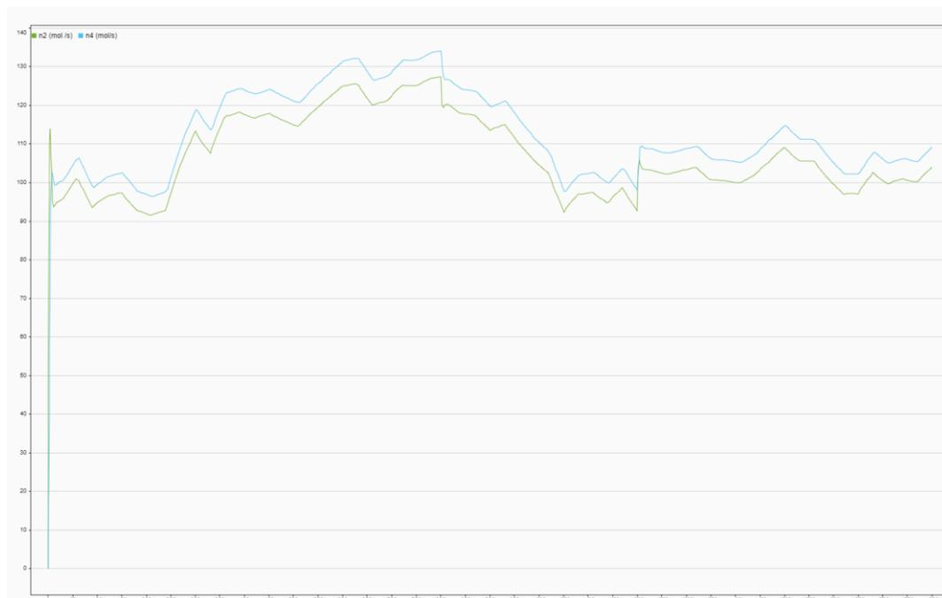
Figura 25. Gráfico para el modelo correspondiente al escenario 1 y el control PID 2DOF que muestra el flujo 2 (en color verde) y el flujo 4 (en color azul). El eje x indica el tiempo en segundos, y el eje y muestra el valor del flujo en  $\text{mol} \cdot \text{s}^{-1}$ . Elaboración propia con MATLAB/Simulink [69].
