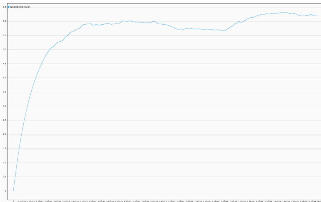
Figura 45. Gráfico para el modelo correspondiente al escenario 2 y el control MPC en el que el eje x indica el tiempo en segundos, y el eje y muestra el valor del flujo del enfriador en  $KJ \cdot s^{-1}$  (KW). Elaboración propia con MATLAB/Simulink [69].
