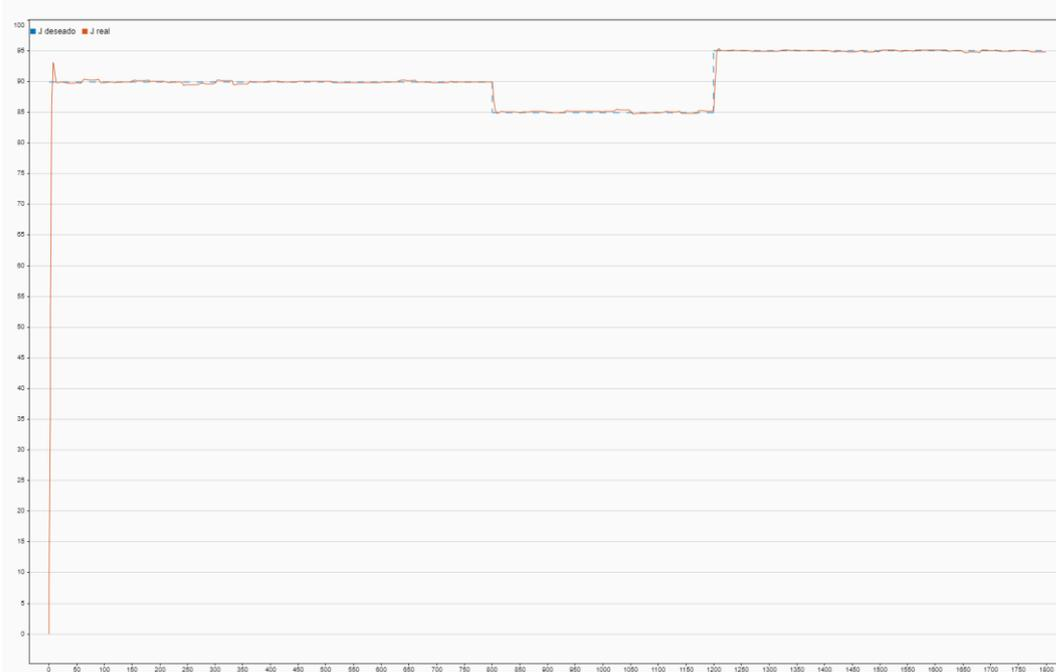
Figura 23. Gráfico que muestra la señal de referencia (en color azul) y la señal real (en color naranja) del tanto por ciento de CO<sub>2</sub> capturado para el escenario 1 y el sistema de control PID 2DOF. El eje x indica el tiempo en segundos, y el eje y muestra el porcentaje de CO<sub>2</sub> capturado. Elaboración propia con MATLAB/Simulink [69].
