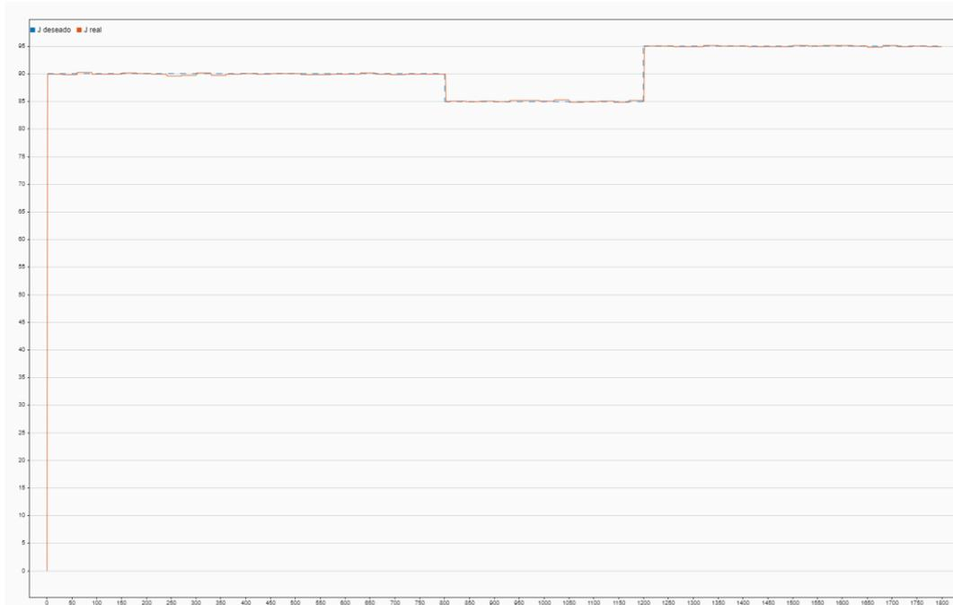
Figura 28. Gráfico que muestra la señal de referencia (en color azul) y la señal real (en color naranja) del tanto por ciento de CO<sub>2</sub> capturado para el escenario 1 y el control MPC. El eje x indica el tiempo en segundos, y el eje y muestra el porcentaje de CO<sub>2</sub> capturado. Elaboración propia con MATLAB/Simulink [69].
