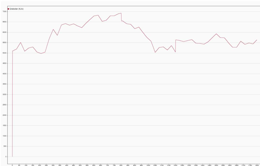
Figura 33. Gráfico para el modelo correspondiente al escenario 1 y el control PID 2DOF en el que el eje x indica el tiempo en segundos, y el eje y muestra el valor del flujo de calor del reboiler en  $KJ \cdot s^{-1}$  (KW). Elaboración propia con MATLAB/Simulink [69].
