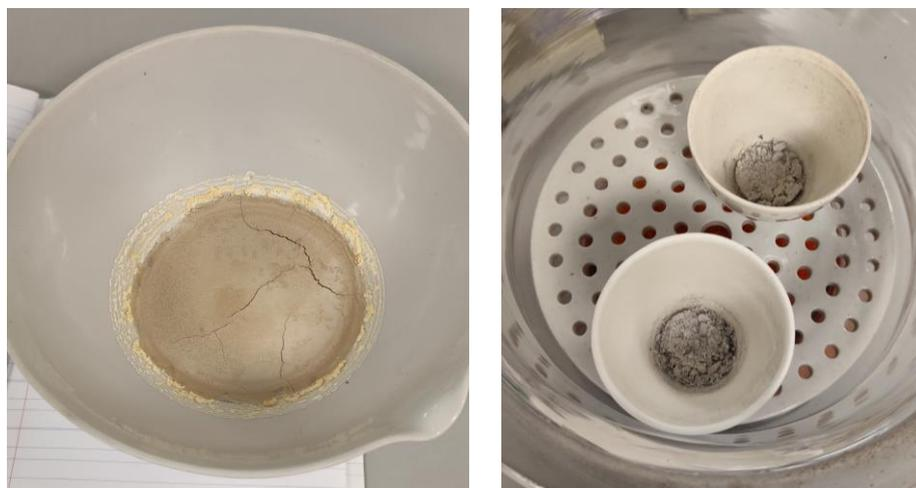
*Figura 10. Cápsula después de estufa y cenizas obtenidas por centrifugación sin lavado*
