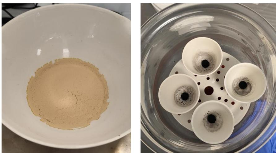
*Figura 11. Cápsula después de estufa y cenizas obtenidas por centrifugación con ciclos de lavado*
