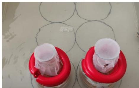
Figura 3. Erlenmeyers con la muestra S/L agitando en el baño termostático multipuesto
