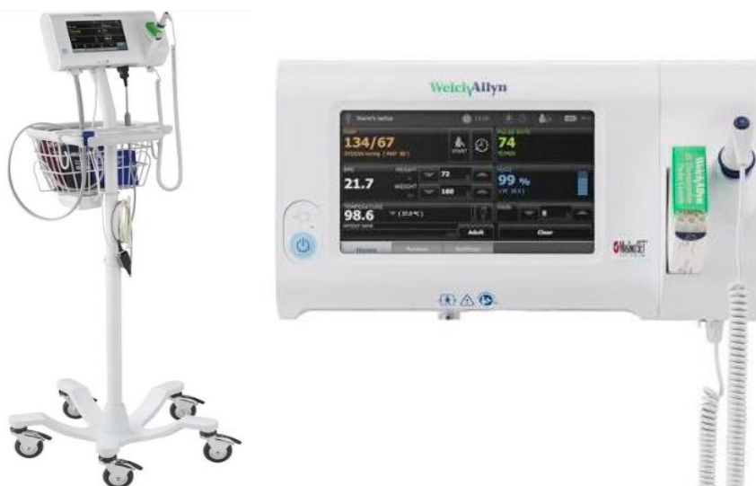
Figura 2: Monitor Welch Allyn Connex Spot para la medida de parámetros fisiológicos.
