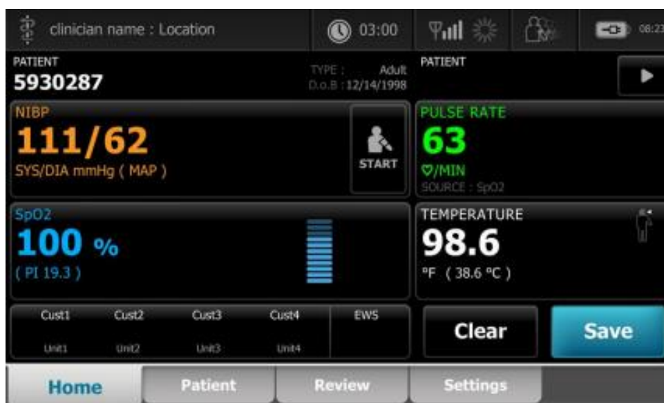
Figura 6: Pantalla de monitorización de parámetros fisiológicos de paciente. ID. Naranja: TA. Verde: Pulso. Azul: SpO 2 . Blanco: Temperatura (°C).
