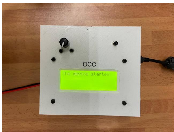
Figura 32: Caja de control de bomba de Liebau con Arduino Nano.
