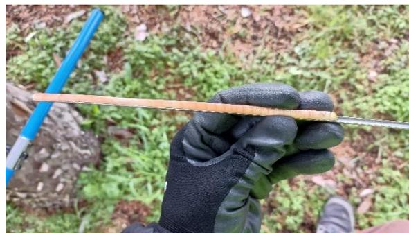
**Imagen 8. Extracción de testigo de madera.**
