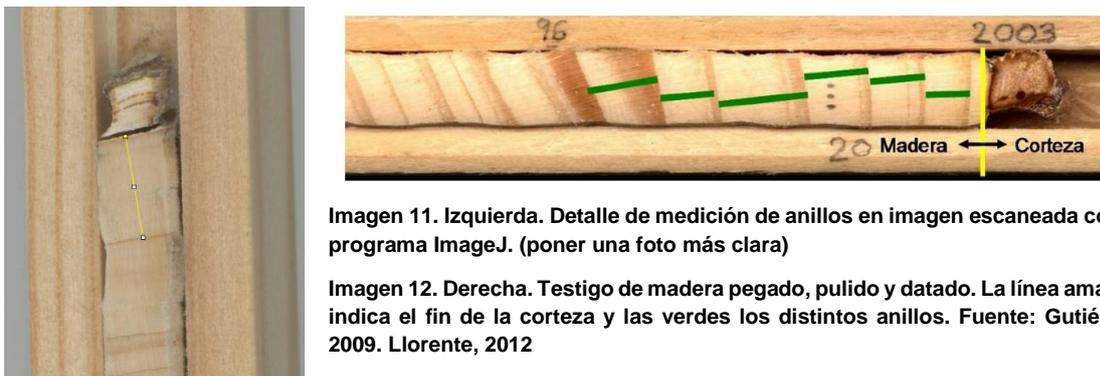
Imagen 11. Izquierda. Detalle de medición de anillos en imagen escaneada con el programa ImageJ. (poner una foto más clara)
