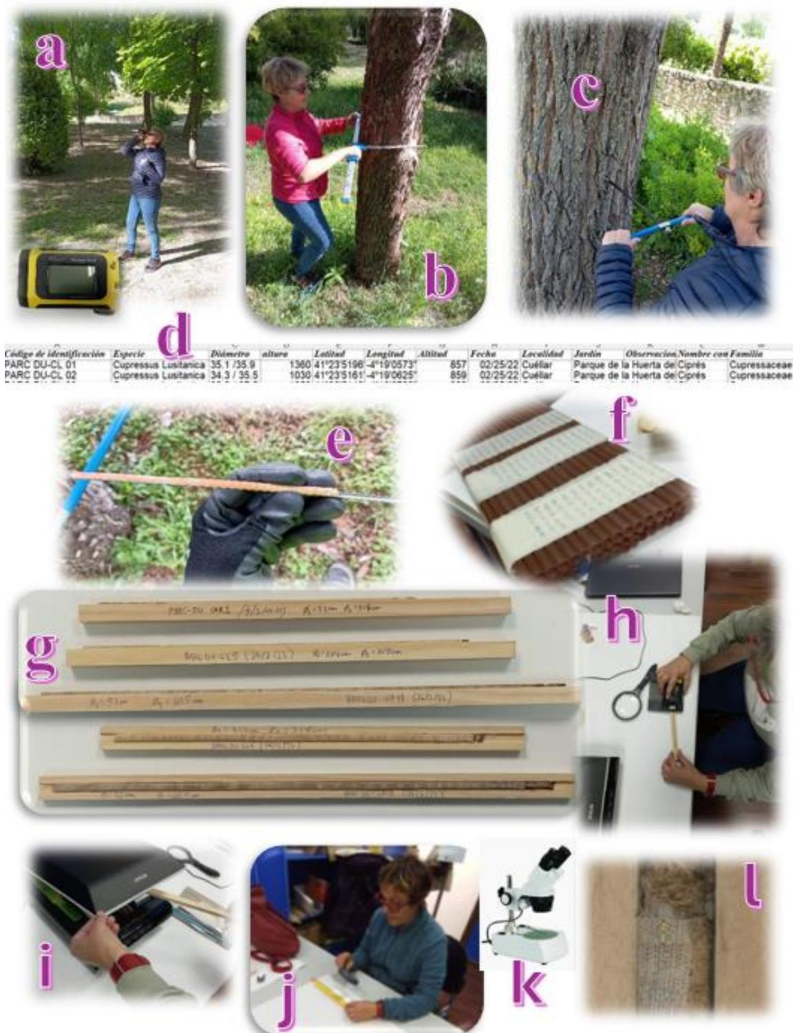
Figura 9. a) Medida de la altura con hipsómetro (Nikon Forestry Pro II, WATERPROOF 6 X 21) b) Medida de DAP con forcípula. c) Muestreo con barrena Pressler. d) Encabezado ficha toma de datos. e) Extracción de testigo de madera. f) Portatestigos. g) Guías con testigos catalogados. h) lijado. i) Escaneado (Epson Perfection V600 Photo). j) Datación de anillos. k) Lupa binocular (XTX 3C LED x40). l) Detalle medida testigo de olmo con ImageJ.
