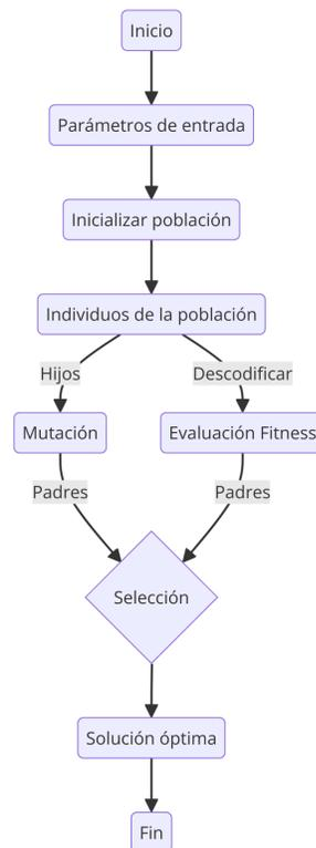
Figura 3.8: Diagrama de flujo básico del funcionamiento de un algoritmo genético
