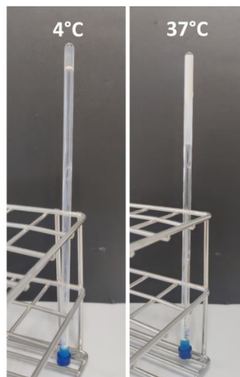
Figura 13: Estudio de la gelificación del polímero TGF\beta(EIS)_2RGD_6V_5H_6 a dos temperaturas.
