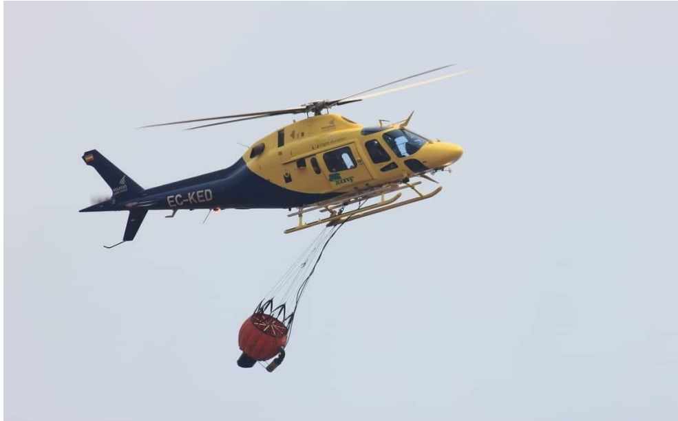
Figura F. . Aeronave con helibalde Bambi Bucket, Chile 2022. Fuente: Propia
