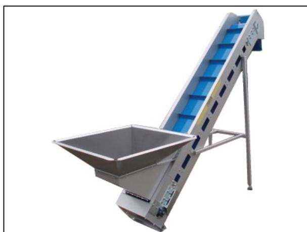
**Figura 28 Cinta transportadora (mezclado – horneado)**
