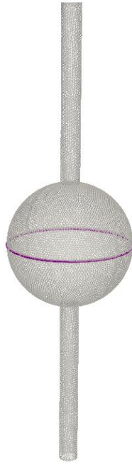
Ilustración 83: Visualización del modelo 'Tubo_R3_L150_SacoR20.stl' incluyendo de color violeta el corte que presenta el diámetro máximo. Fuente: Propia.
