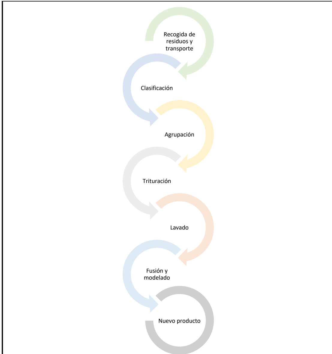
Figura 46: Proceso de reciclaje de envases y plásticos
