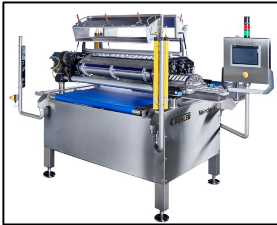
Figura 29: Máquina depositadora de galletas
