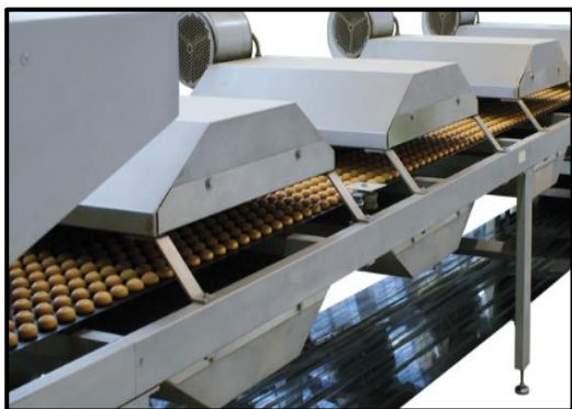
Figura 31: Unidad de refrigeración por aire
