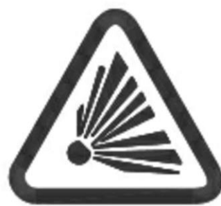
RIESGO DE EXPLOSION
