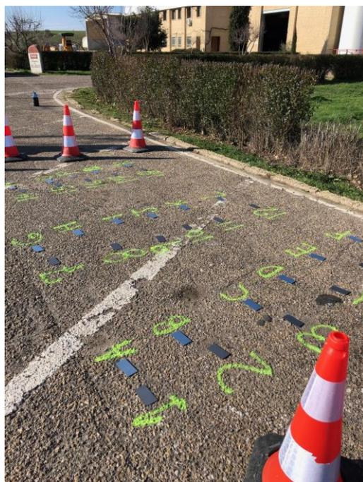
**Figura 42.** Fotografía de la disposición de placas de acero al carbono y galvanizado bajo condiciones ambientales. Las placas de acero galvanizado y acero al carbono se identifican con números y letras, respectivamente. Tres grupos son expuestos a la intemperie, grupo control sin tratamiento, grupo tratado con salmuera (23% m/V) y grupo tratado con salmuera (23% m/V) más aditivos.
