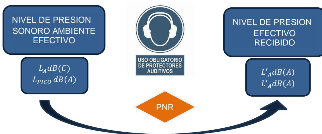
**Ilustración 7.** Reducción prevista del nivel de ruido (PNR). Propio
