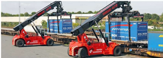
Figure 38 : Proceso de transbordo RO-LO(Fuente: Kubanova & Schmidt, 2016)
