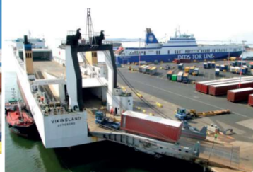
Figure 36 : Proceso de transbordo RO-RO(Fuente: Kubanova & Schmidt, 2016)
