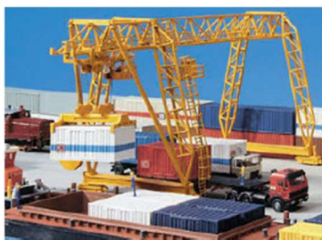
Figure 35 : Proceso de transbordo LO-LO((Fuente: Kubanova & Schmidt, 2016)
