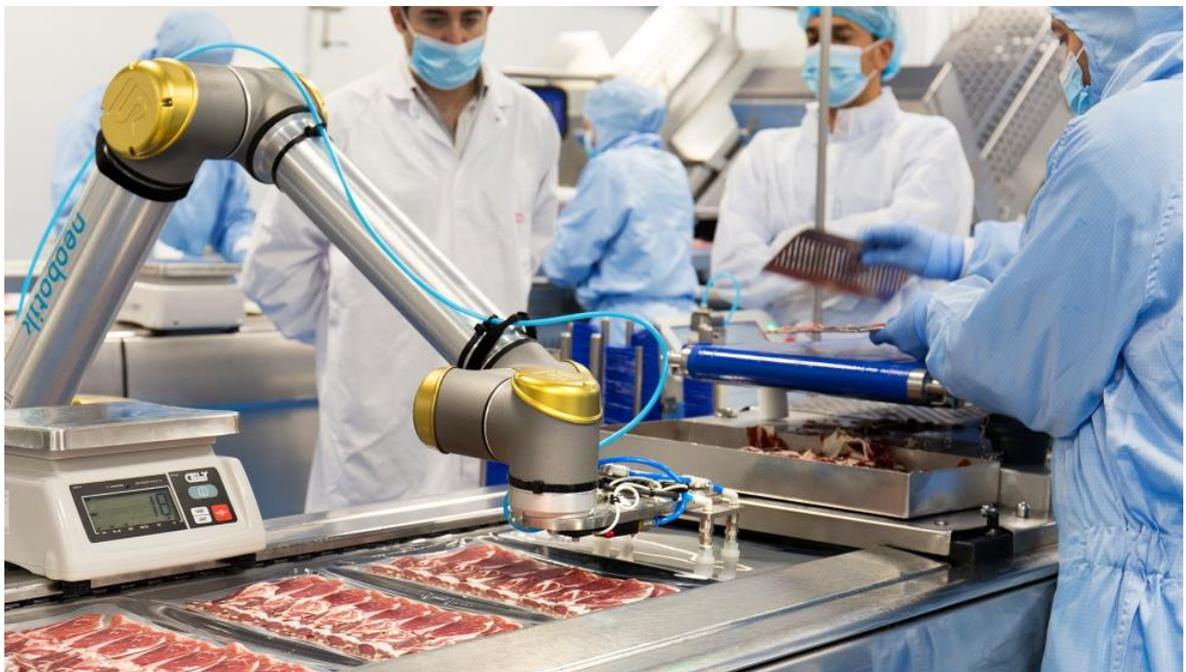
Figura 4.4 Cobot en operación de envasado al vacío (Interempresas,2020)
