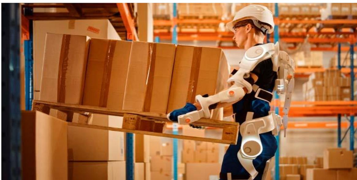
**Figura 4.6 Ilustración de exoesqueleto para manipulación de cargas (Iberdrola,2024)**
