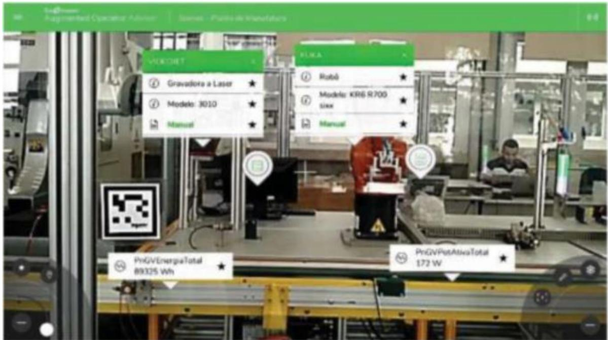
Figura 3.12 Aplicación de la RA para el monitoreo de consumo de energía en una planta (Chu & Pan 2024)
