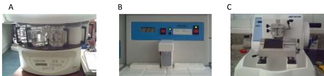
Figura 2. A) Procesador de tejidos; B) Dispensador de parafina; C) Microtomo.
