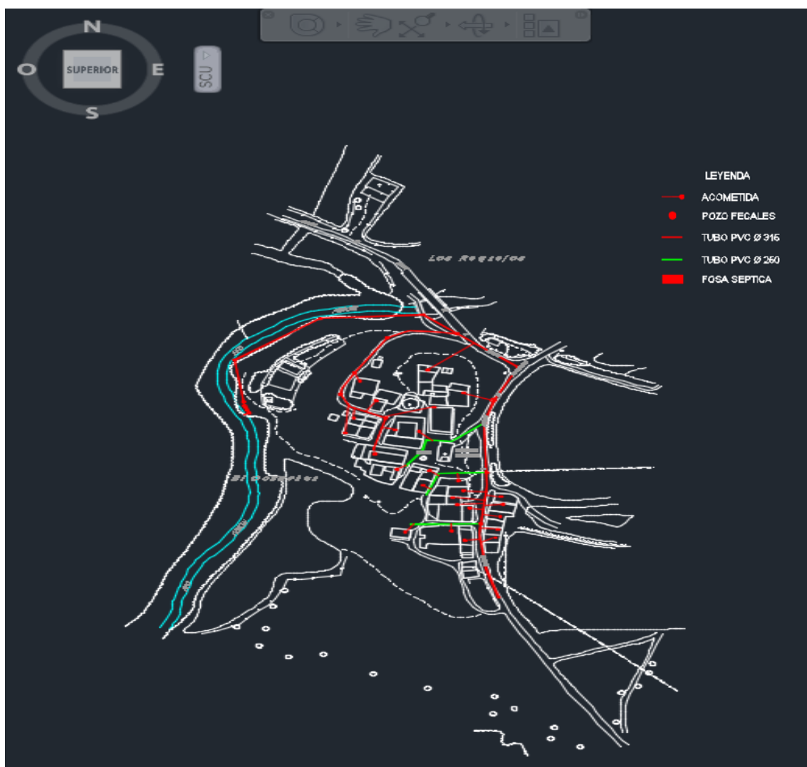
Figura 1: Red de saneamiento de Abioncillo realizado a partir de los Plan de la Delimitación del Suelo Urbano
