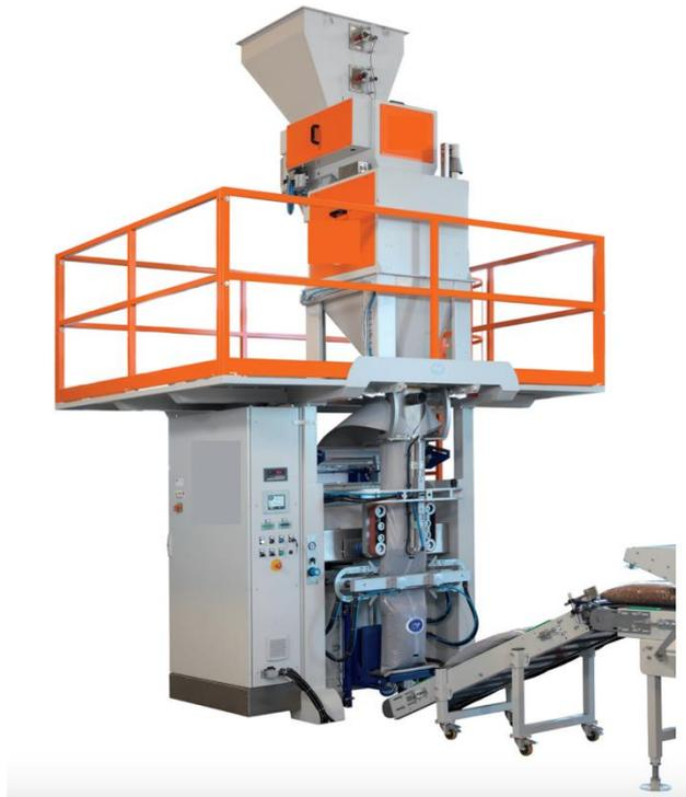
Figura 17. Instalación semiautomática de dosificación y relleno de sacos de papel
