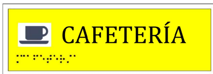
Ilustración 176: Ejemplo de incorporación de pictograma, texto y braille en la composición de una señal accesible
