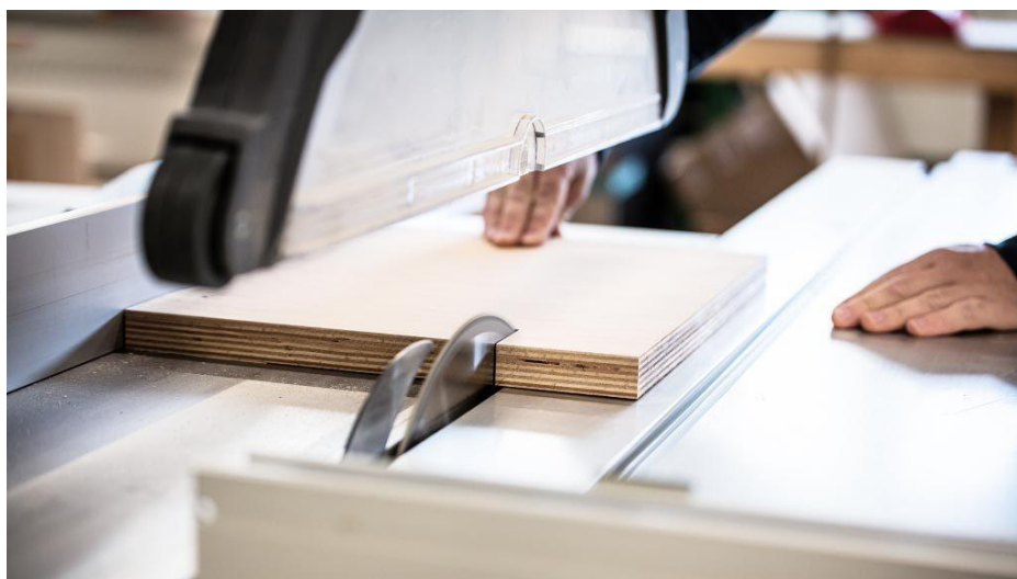
Ilustración 103: Operario utilizando una sierra circular de mesa
