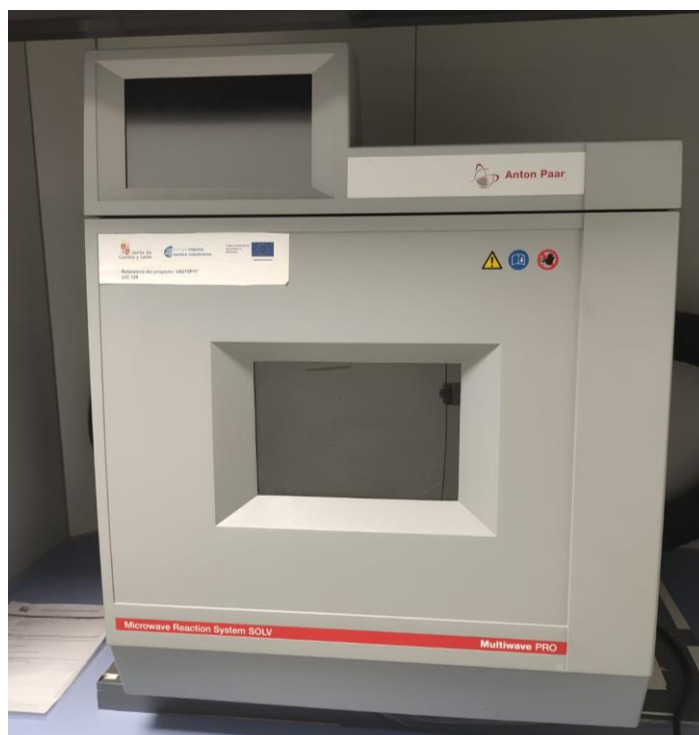
Figura 11. Microondas utilizado para el proceso de extracción (elaboración propia) (ISP - Instituto de Procesos Sostenibles de La UVA, n.d.)
