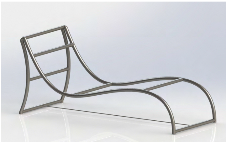
Fig 149. Imagen de la estructura de acero interior
