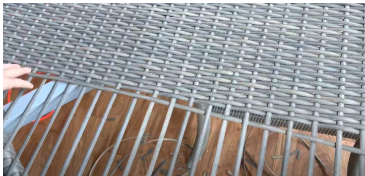
Fig 178. Trenzado de la fibra
