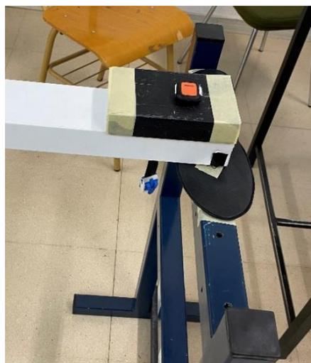
Figura 7. Detalle de la masa situada en el extremo de la viga.
