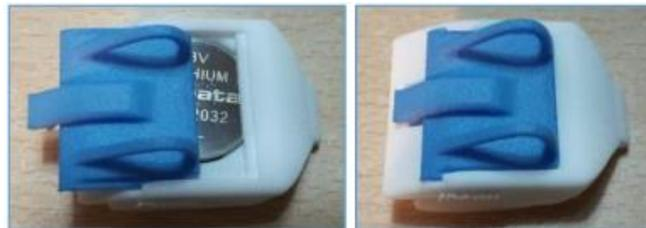
Figura 11. Detalle inserción batería y cerrar clip de la batería [13].
