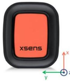
Figura 9. Sistema de coordenadas del sensor Xsens DOT [11].
