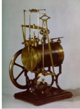
FIGURA 22. Regulador de Watt. (Brunete, San Segundo, & Herrero, 2024)
