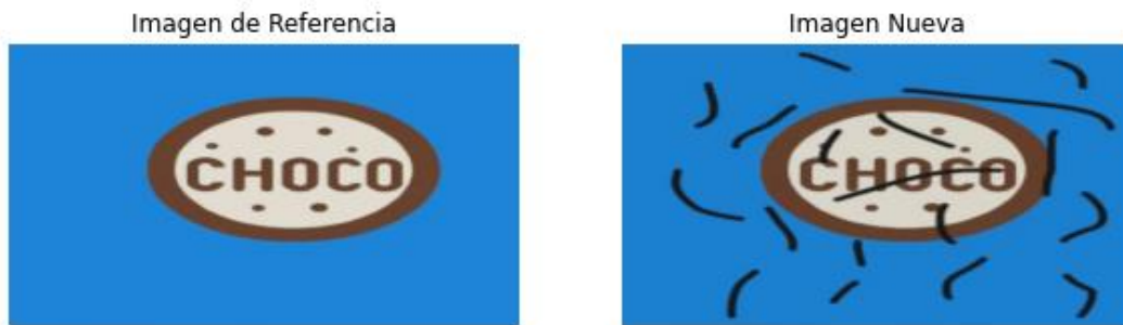
FIGURA 166. Visualización de la caja de referencia y la caja nueva defectuosa de choco en Python.
