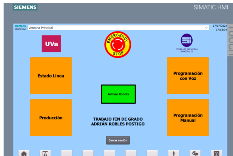
FIGURA 174. Seta de emergencia activada en TIA Portal V16.
