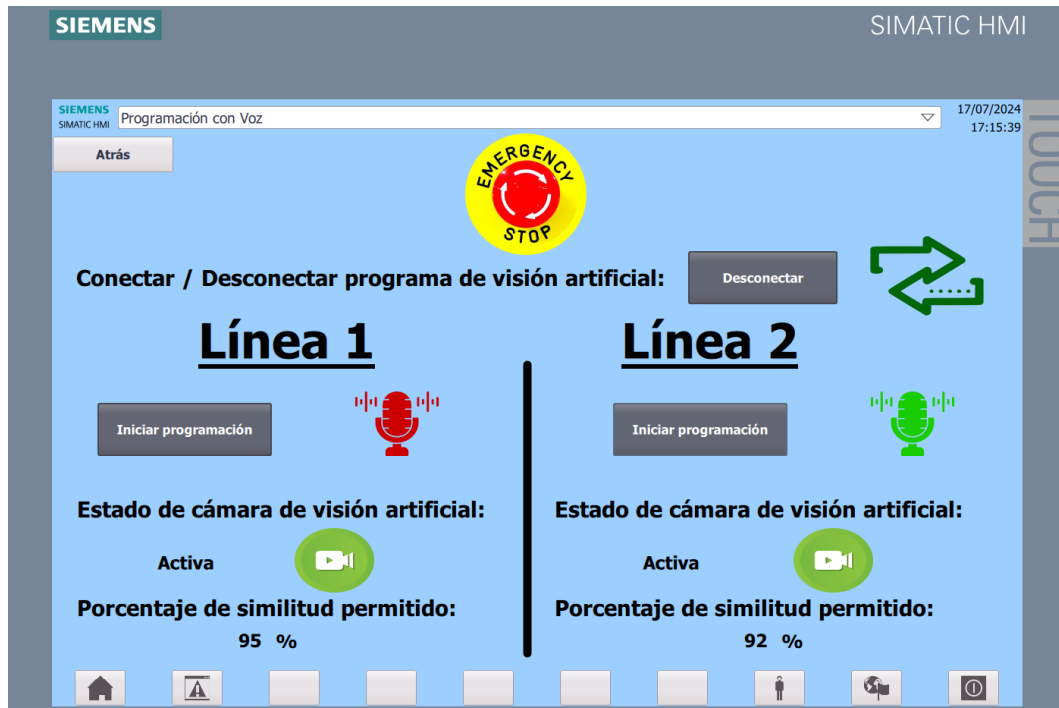
FIGURA 150. Programación del paletizado por voz desde la HMI en TIA Portal V16.
