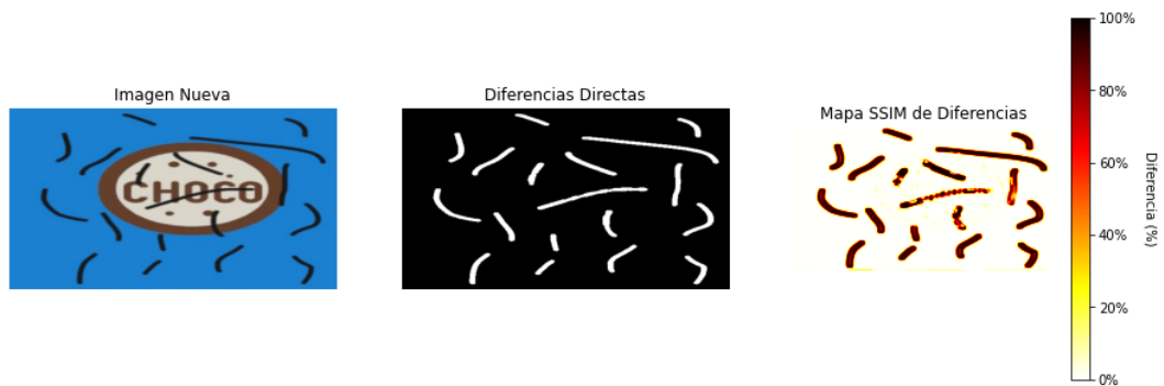
FIGURA 167. Diferencias entre la caja de referencia y la caja nueva defectuosa de choco con diferencias en Python.
