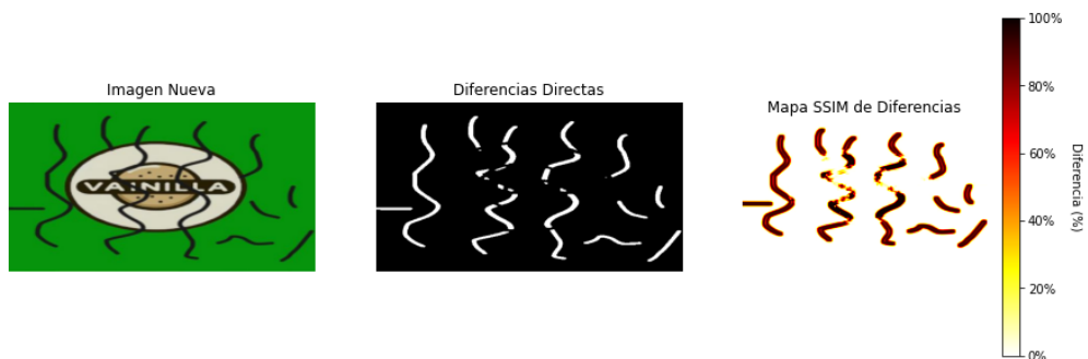
FIGURA 164. Diferencias entre la caja de referencia y la caja nueva defectuosa de vainilla con diferencias en Python.
