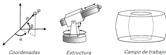
FIGURA 17. Coordenadas, estructura y campo de trabajo de robot esférico o polar. (Fraile Marinero, 2023)
