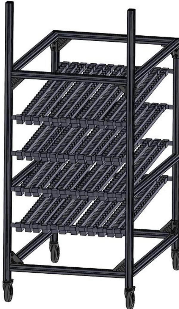
**FIGURA 139. ESTRUCTURA DE LA LAVADORA CON LOS CAMINOS DE RODILLOS. (ELABORACIÓN PROPIA)**
