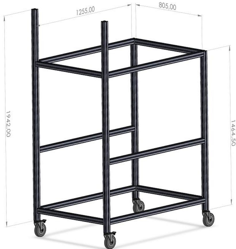
**FIGURA 136. MEDIDAS DE LA ESTRUCTURA BASE. (ELABORACIÓN PROPIA)**
