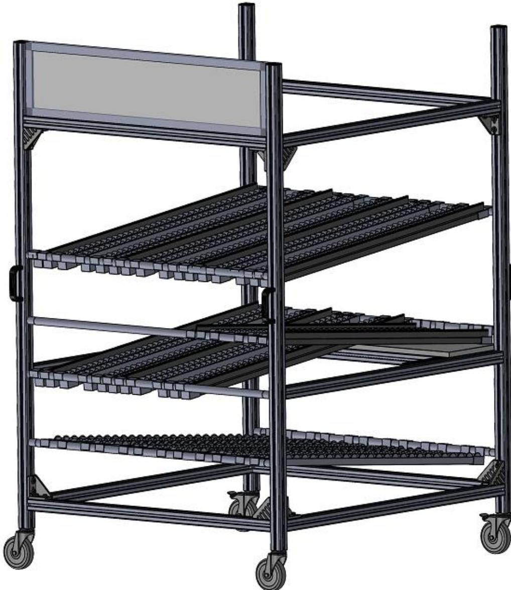
FIGURA 123. PUESTO DE ABASTECIMIENTO DE LA LÍNEA DE MONTAJE DEL COCHE. (ELABORACIÓN PROPIA)
