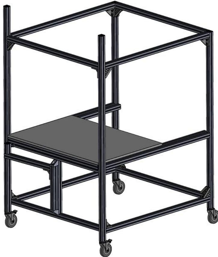
**FIGURA 132. MESA RECOGIDA INSERTADA EN EL PUESTO. (ELABORACIÓN PROPIA)**
