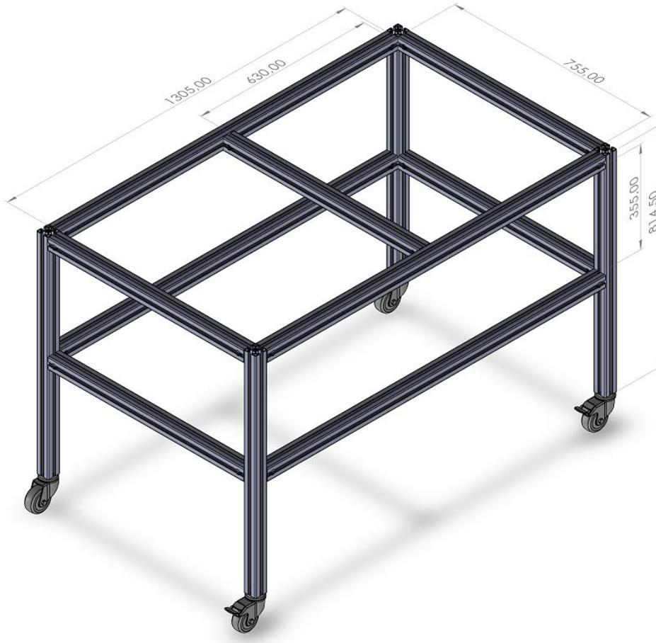
**FIGURA 100. MEDIDAS DE LA ESTRUCTURA BASE. (ELABORACIÓN PROPIA)**
