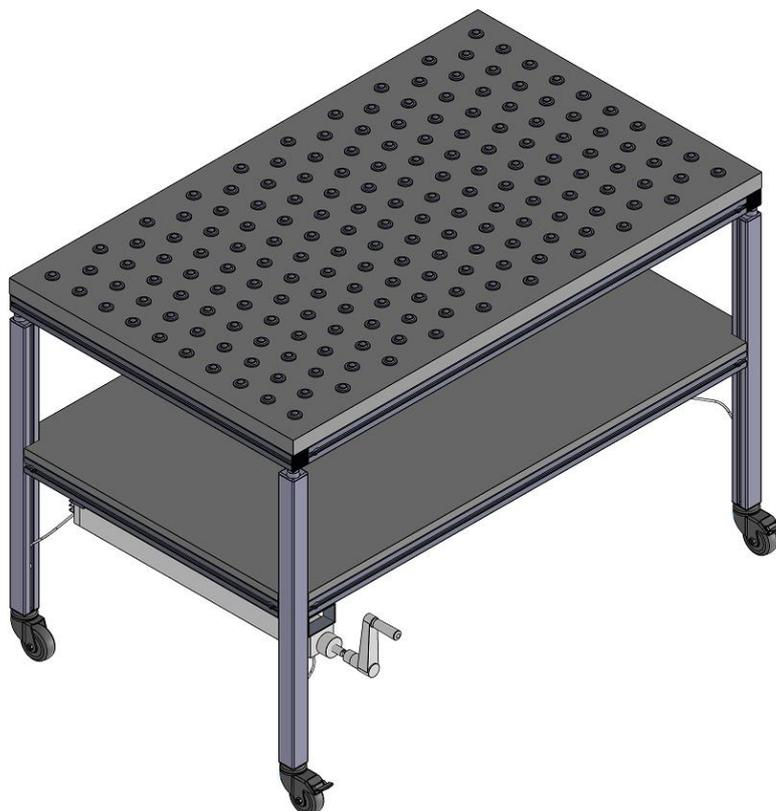
FIGURA 97. MESA DE MONTAJE CON TABLERO DE BOLAS. (ELABORACIÓN PROPIA)
