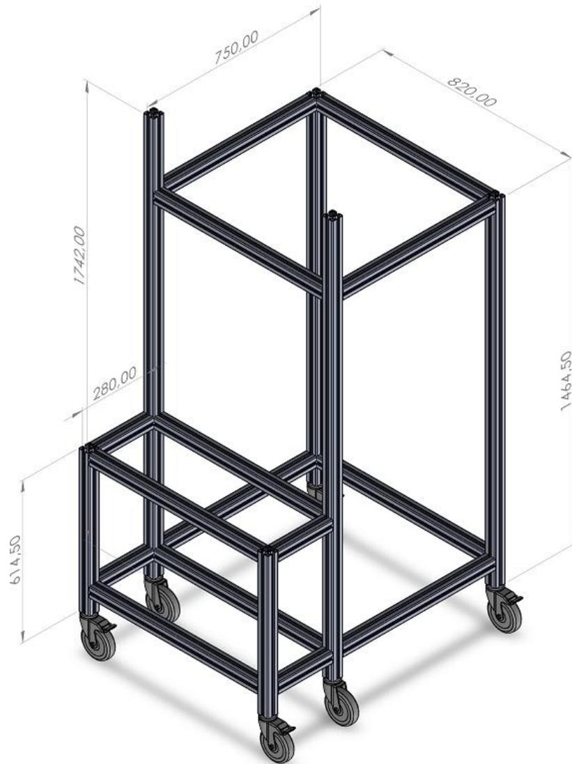
**FIGURA 103. MEDIDAS DE LA ESTRUCTURA BASE. (ELABORACIÓN PROPIA)**
