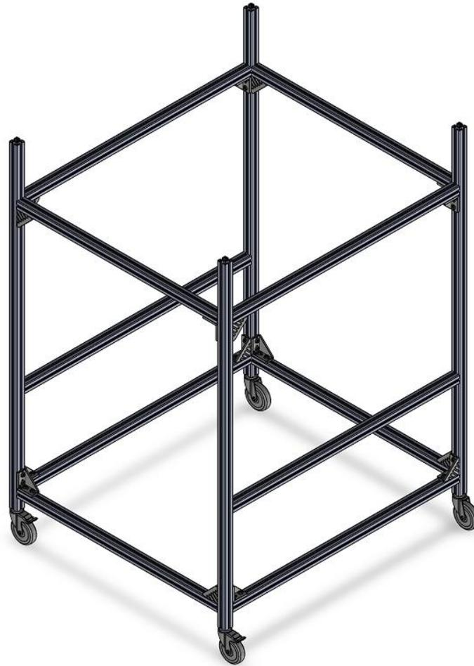
**FIGURA 113. ESTRUCTURA DEL PUESTO DE RECICLAJE/ABASTECIMIENTO CON ESCUADRAS.
