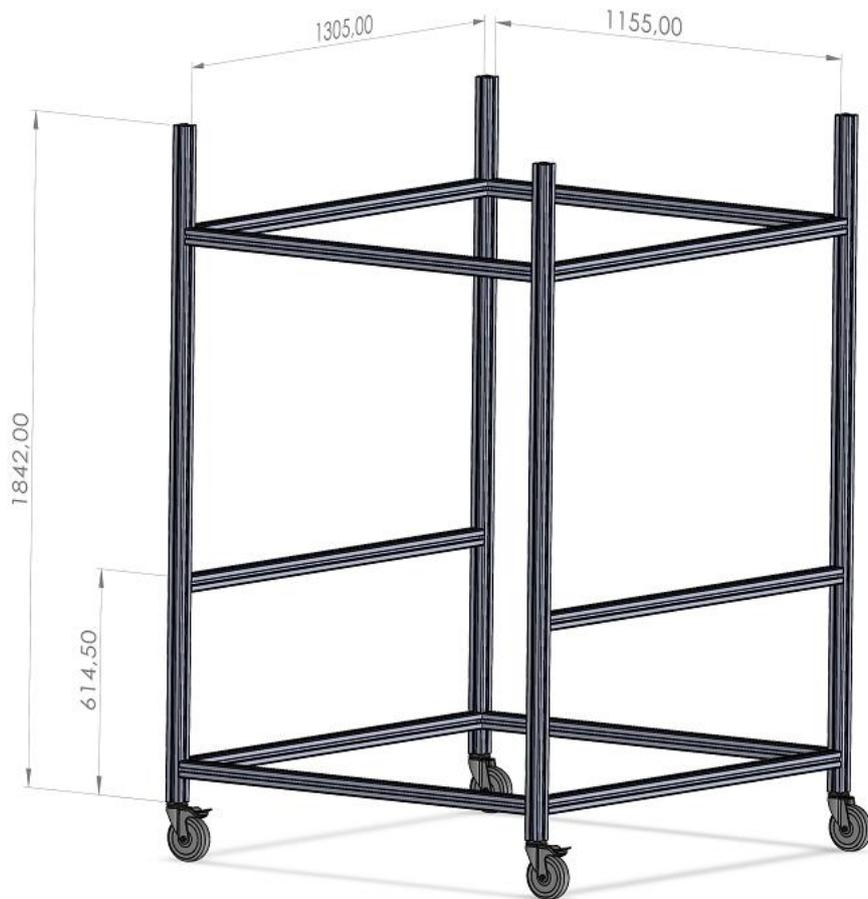
**FIGURA 112. MEDIDAS DE LA ESTRUCTURA BASE. (ELABORACIÓN PROPIA)**
