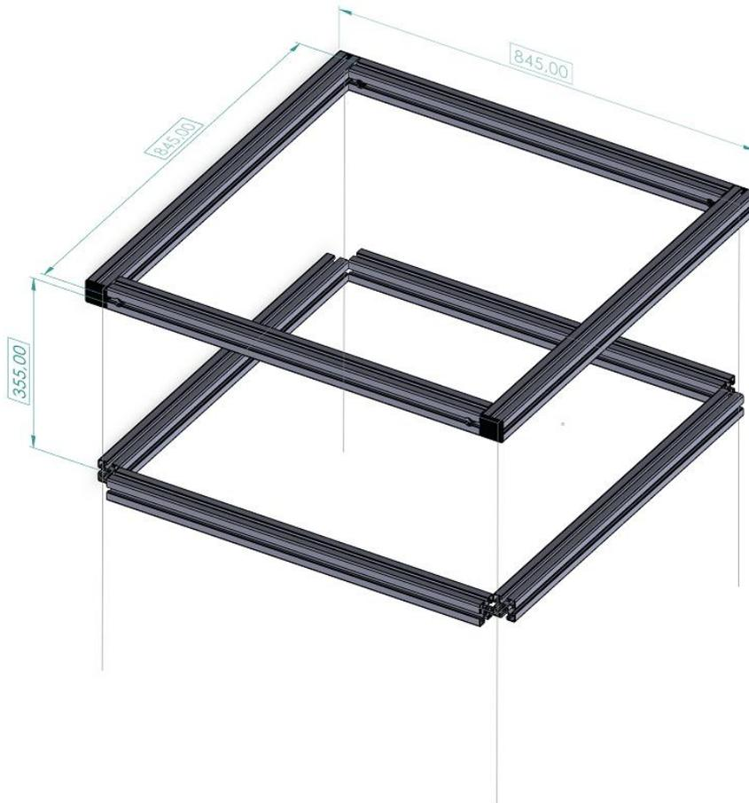
**FIGURA 87. MEDIDAS DE LA ESTRUCTURA DE LA MESA USANDO FRAMEPRO. (ELABORACIÓN PROPIA)**
