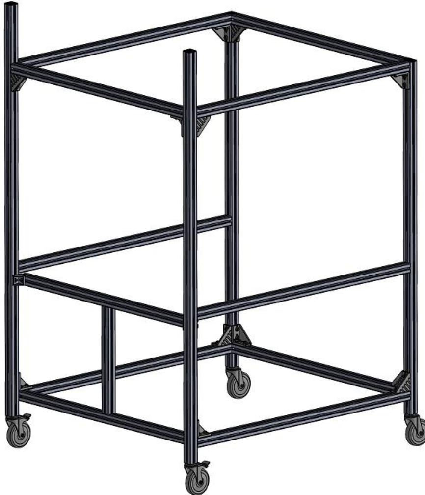
**FIGURA 125. ESTRUCTURA DEL PUESTO DE MONTAJE CON ESCUADRAS. (ELABORACIÓN PROPIA)**
