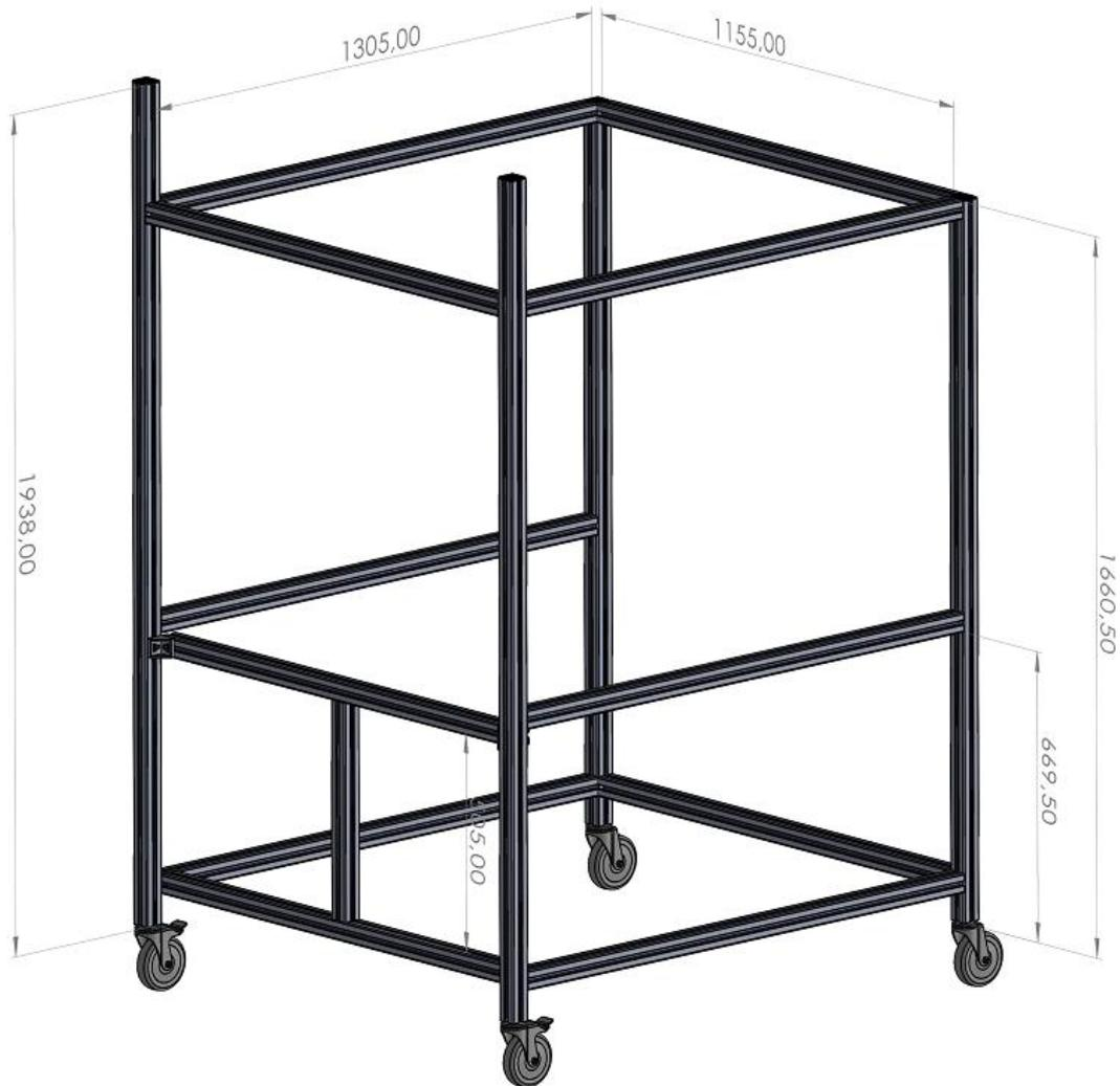
**FIGURA 124. MEDIDAS DE LA ESTRUCTURA BASE. (ELABORACIÓN PROPIA)**
