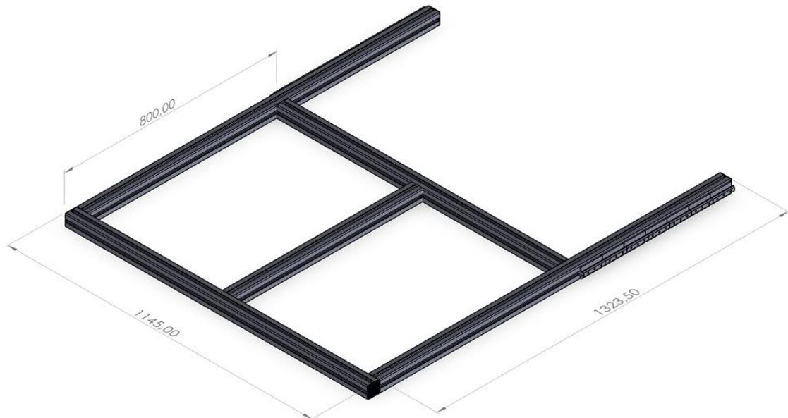
**FIGURA 126. ESTRUCTURA DE LA MESA DESLIZABLE DEL PUESTO DE MONTAJE. (ELABORACIÓN PROPIA)**
