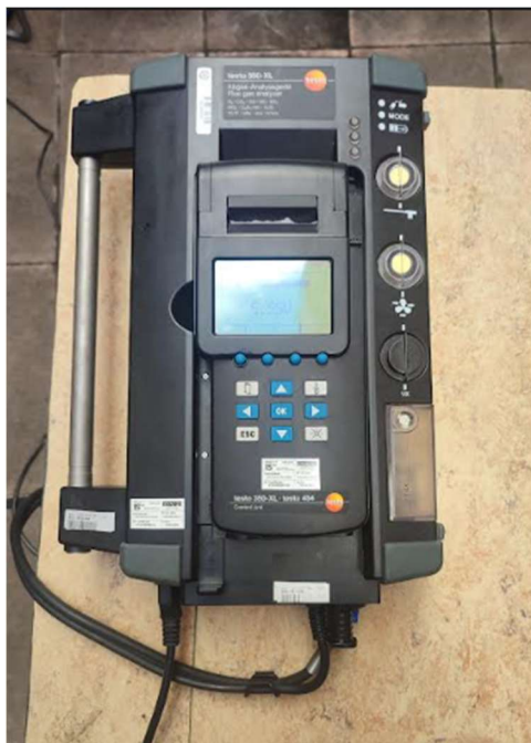
FIG.9: Analizador de la combustión (Elaboración propia)
