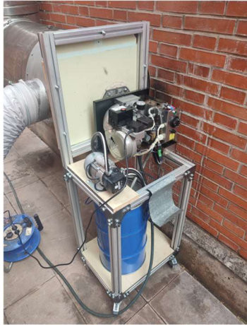
FIG. 6: a) Quemador de pulverización asistida por aire b) Quemador de emulsión de aire (Elaboración propia)
