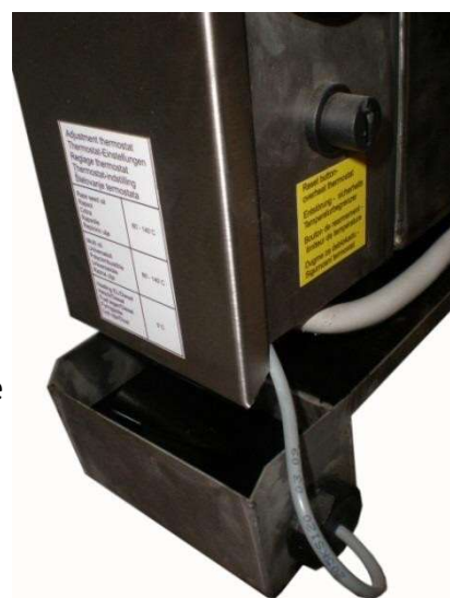
Depósito de rebose
