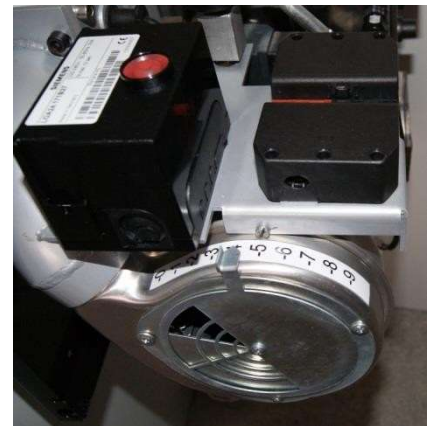
Regulador de aire secundario (quemador Cyclon serie-J)
