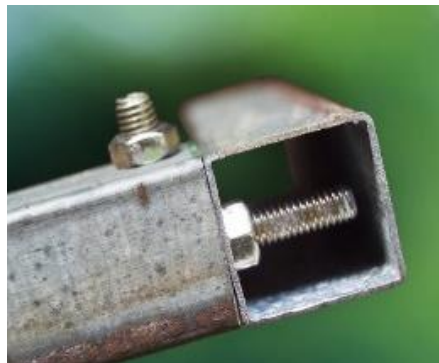
Figura 34. Unión atornillada de dos perfiles cuadrados. [53]
