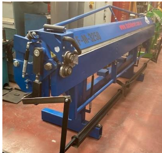
Figura 71. Plegadora para aluminio Dachdecker ZRF-3250 con cortador. [65]
