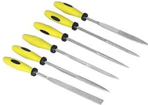
Figura 73. Limas de agujas planas y dientes finos. [67]
