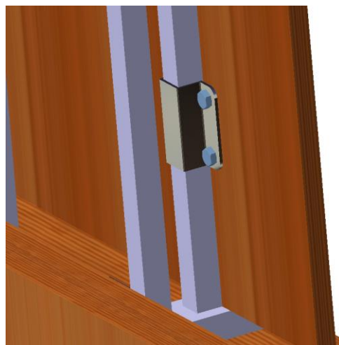
Figura 65. Abrazadera tipo omega anclada al artesonado mediante tornillos.
