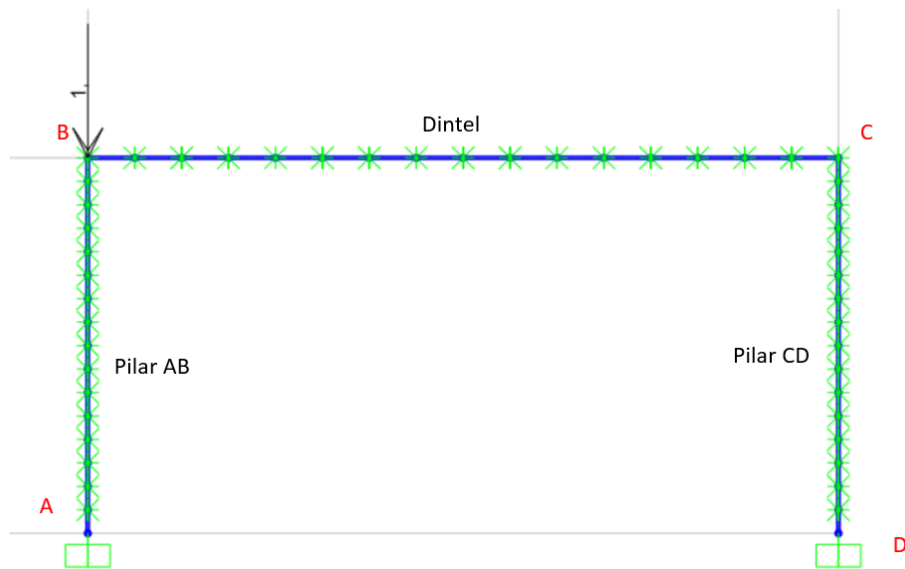
Figura 3.22: Caso de cargas para pórticos
