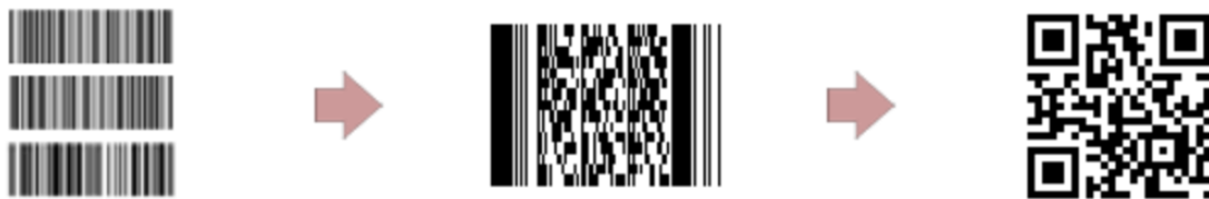
Figura 15. Evolución códigos de barras estándar, a códigos de barras 2D, a QRs [10]
