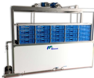
Ilustración 15. Saladero de cajas Fuente: www.instalacioneslacteasremma.com
