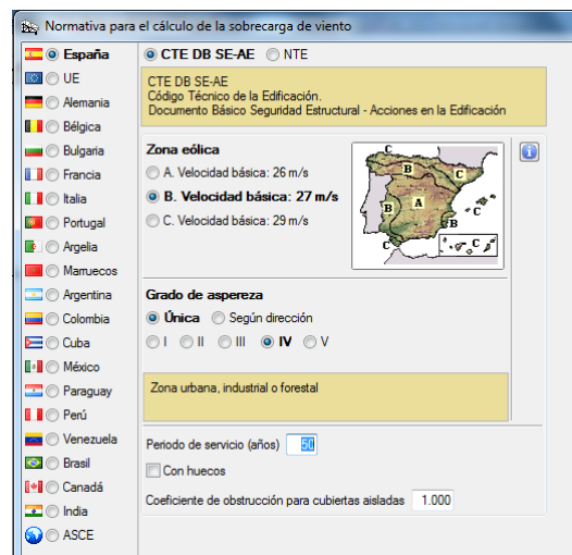
Ilustración 42. Normativa para el cálculo de la sobrecarga de viento Fuente: Elaboración propia
