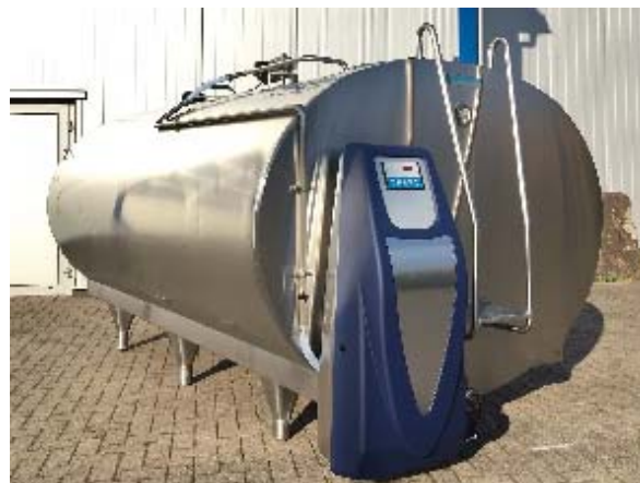
Ilustración 10. Tanque de almacenamiento isoterma Marca Risto, mod-O-900
