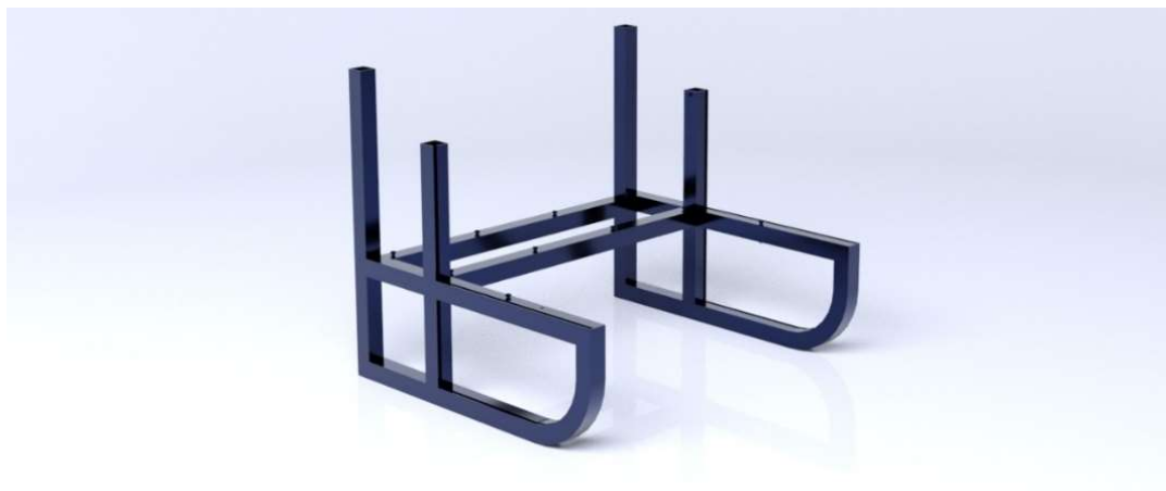
Ilustración 31. Render detalle conjunto estático estructura
