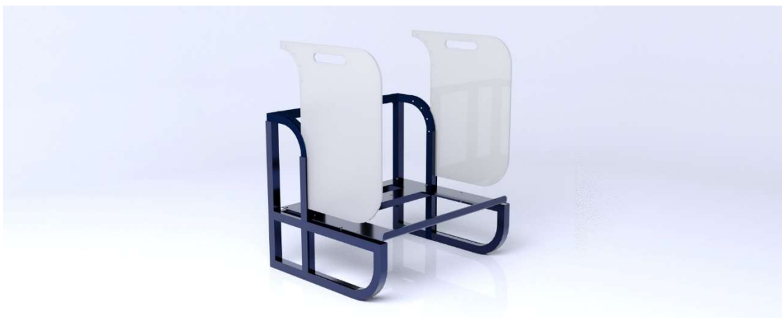
Ilustración 112. Render detalle montaje paneles sobre estructura
