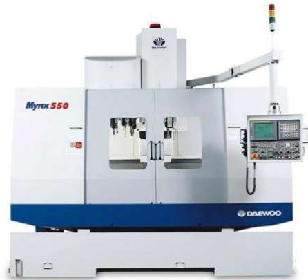
Ilustración 87. Fotografía centro de mecanizado CNC
