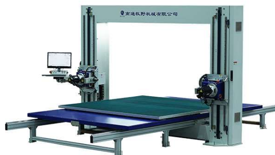
Ilustración 84. Fotografía cortadora de alambre horizontal CNC
