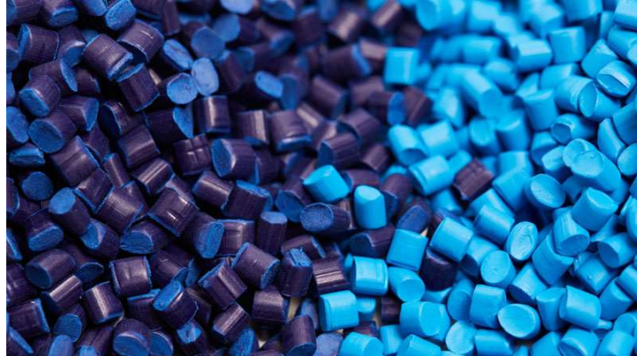
Ilustración 66. Fotografía pellets de polipropileno
