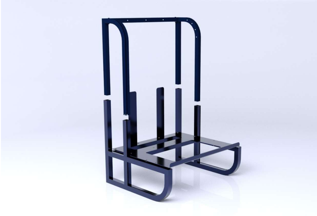
Ilustración 111. Render detalle montaje conjunto móvil sobre conjunto estático
