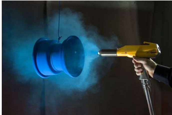
Ilustración 90. Fotografía pistola electrostática para aplicación pintura en polvo
