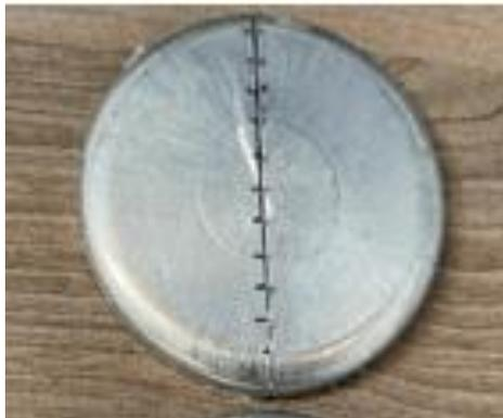
*Figura 19: Base seccionada de un envase para realizar las medidas del perfil.*
