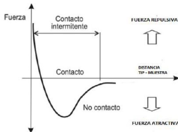
Fig 3. Fuerza en función de la distancia entre muestra y tip [3].
