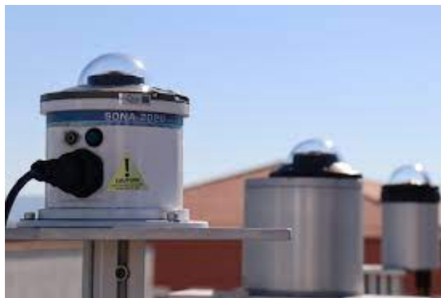
Figura 5: Cámara de cielo SONA 202-NF utilizada por el grupo GOA en la Universidad de Valladolid. Fuente: Tesis doctoral de J. C. Antuña [2]
