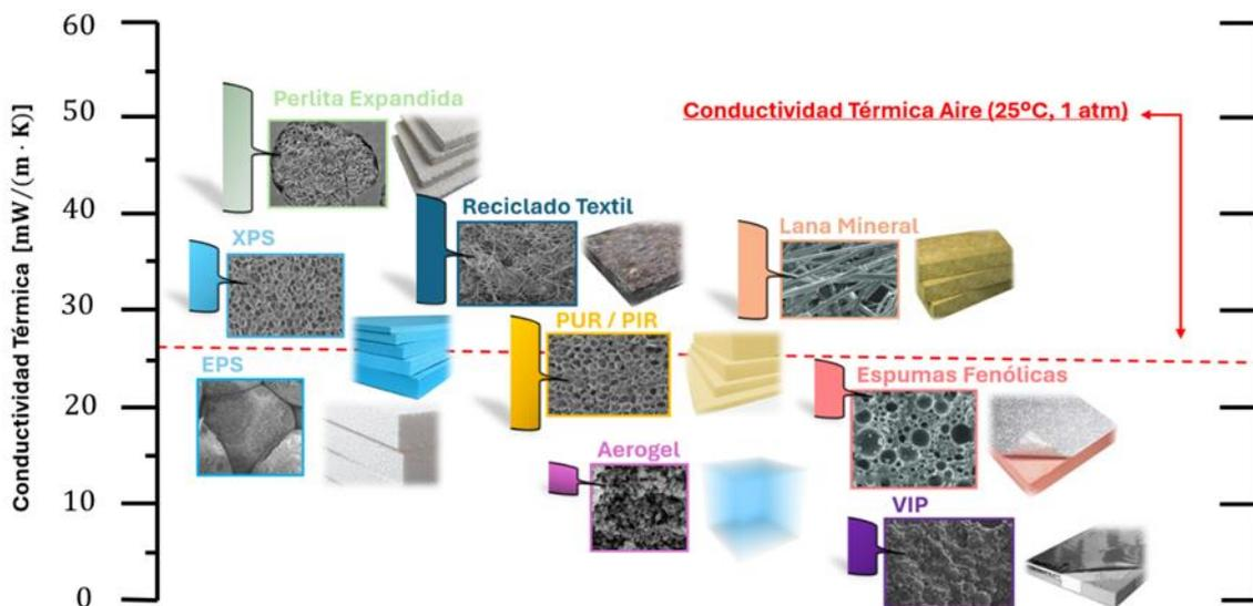
**Figura 6.** Rendimiento térmico de diferentes aislantes comerciales. Adaptada de [28].
