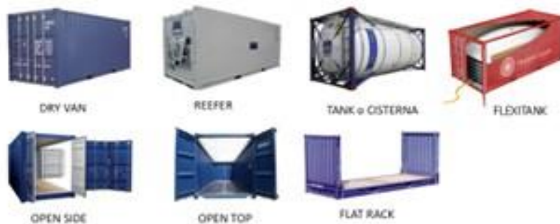
Ilustración 5: Tipos de contenedores marítimos
