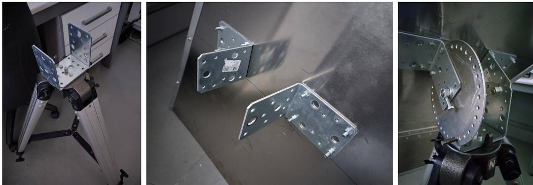
Figura 15: Escuadras fijadas a la montura, a la bocina y resultado final una vez ensamblado todo.
