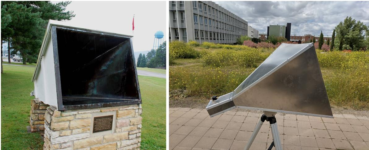
Figura 3: A la izquierda, antena de bocina piramidal que usaron Ewen y Purcell para la primera detección de la línea de 21 cm. A la derecha, la nuestra una vez montada. Fuente: [2].
