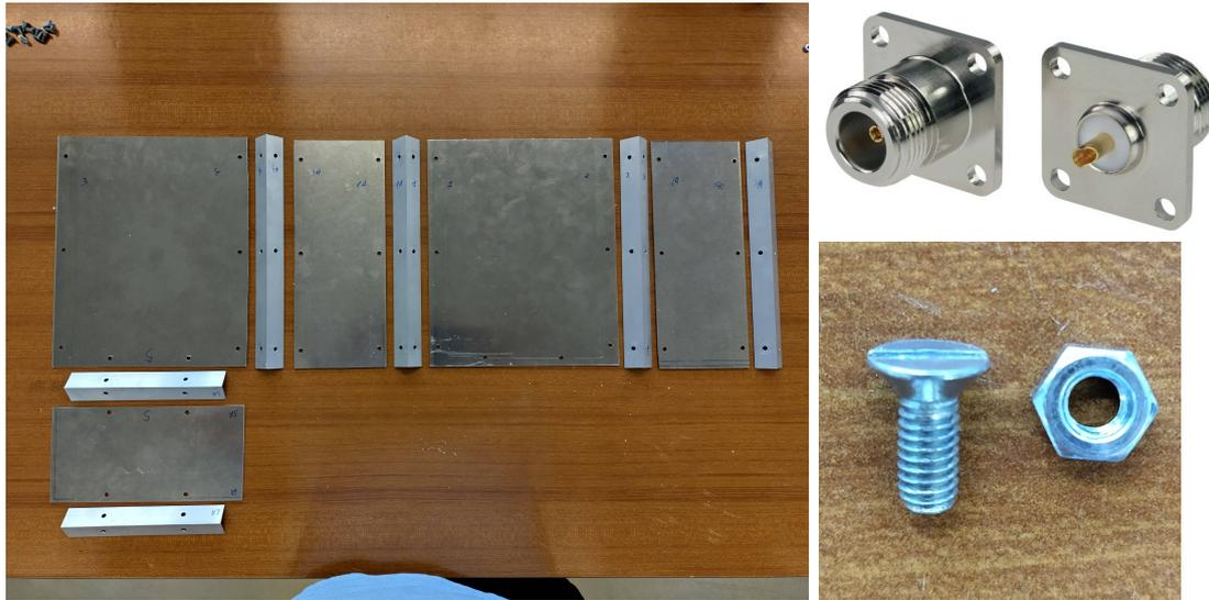
Figura 12: A la izquierda, piezas de la guía de ondas recortadas de la lámina junto con los perfiles para unirlos. A la derecha, conector N hembra y tornillos M4 avellanados.
