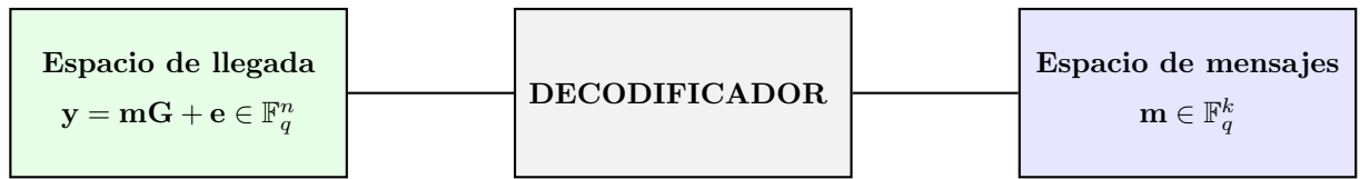
Figura 7.6: Esquema básico de la decodificación. m es el mensaje, G es la matriz de codificación, e es el ruido.
