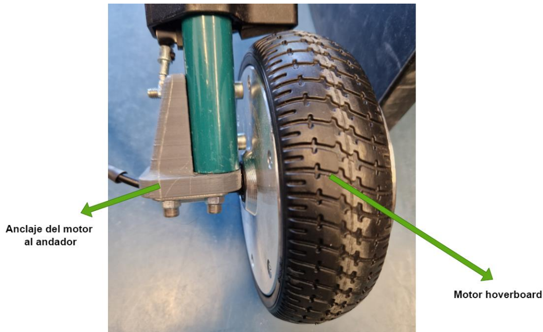
Figura 52, anclaje de los motores al andador
