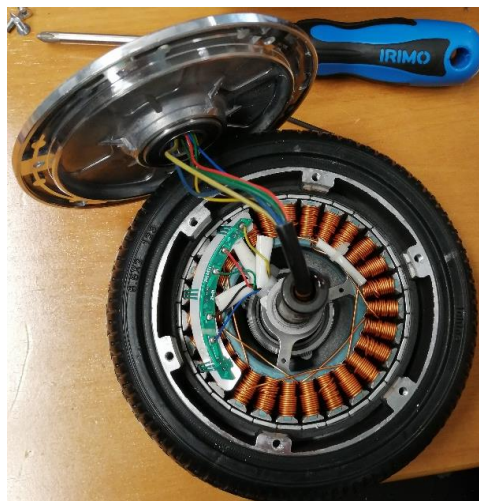
Figura 18, interior del motor del hoverboard
