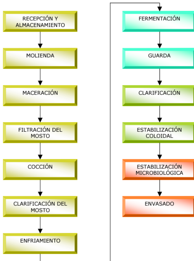
Figura 6. Diagrama general de proceso de producción de cerveza [24]
